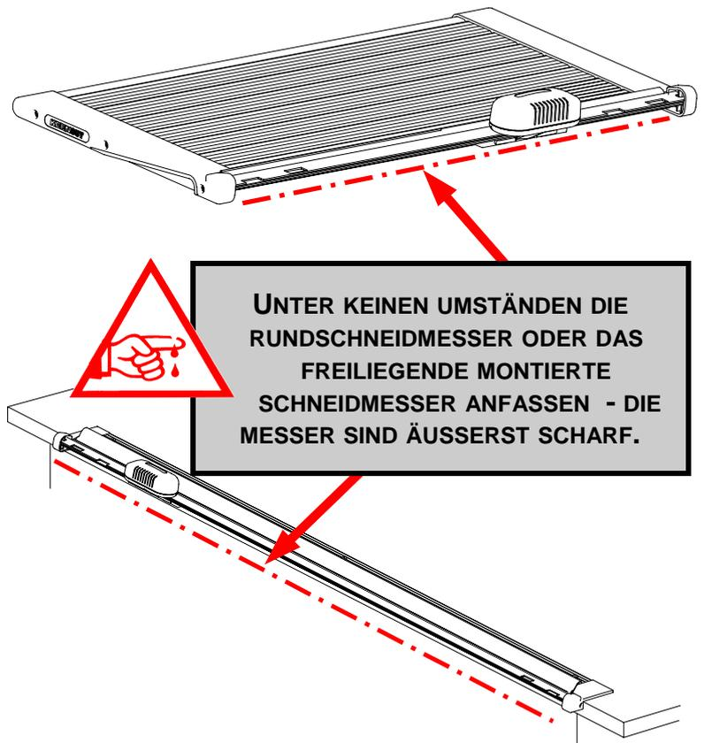
Die Schneidgeräte wurden dazu ausgelegt, eine Vielfalt an Materialien mit einer Dicke von bis zu 2 mm zu schneiden. Das einzigartige Konzept, den Schneidkopf auf einem Gleitlagersystem unterhalb der Oberfläche des Bodens zu bewegen, sorgt dafür, dass die Schneiddicke unabhängig von der Länge der Maschine eingehalten wird.
